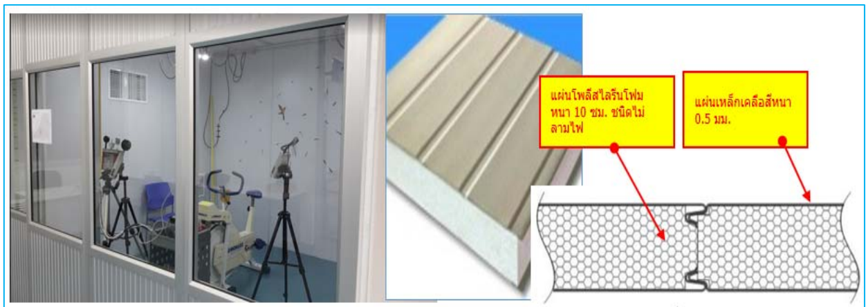
รูปที่ 7.2 ห้องควบคุมอุณหภูมิที่ใช้ในงานวิจัยครั้งนี้
