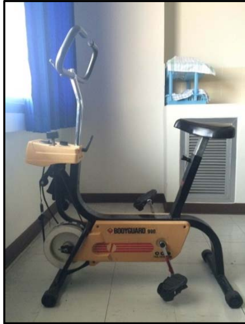
รูปที่ 7.3 จักรยานวัดงานที่ใช้ในการทดสอบสามารถปรับความหนักเบาได้
